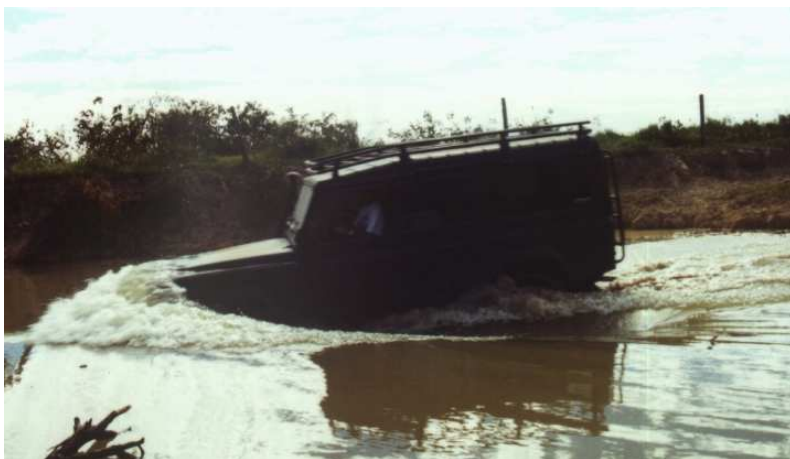
A formação de uma pequena onda à frente do veículo garante maior tranquilidade na travessia.
